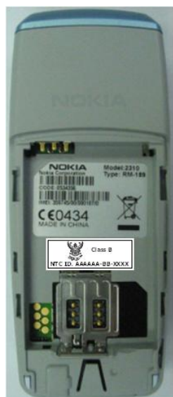
รูปที่ 5 การติดเครื่องหมายที่เครื่องโทรคมนาคม
